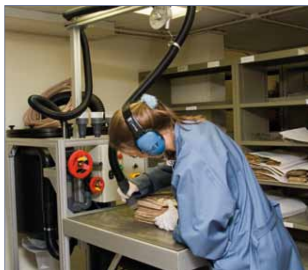
Met een archiefstofzuiger worden documenten op veilige wijze gereinigd
